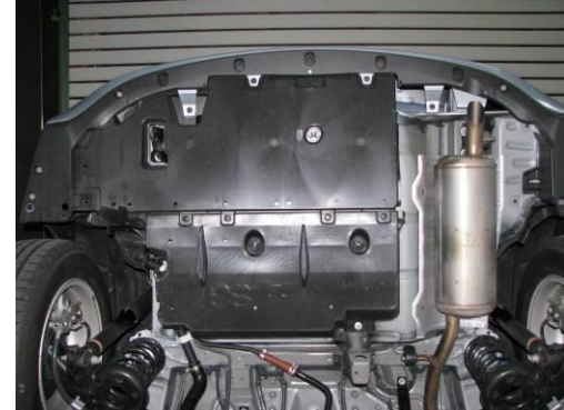
HV-Batterie im Kofferraum
